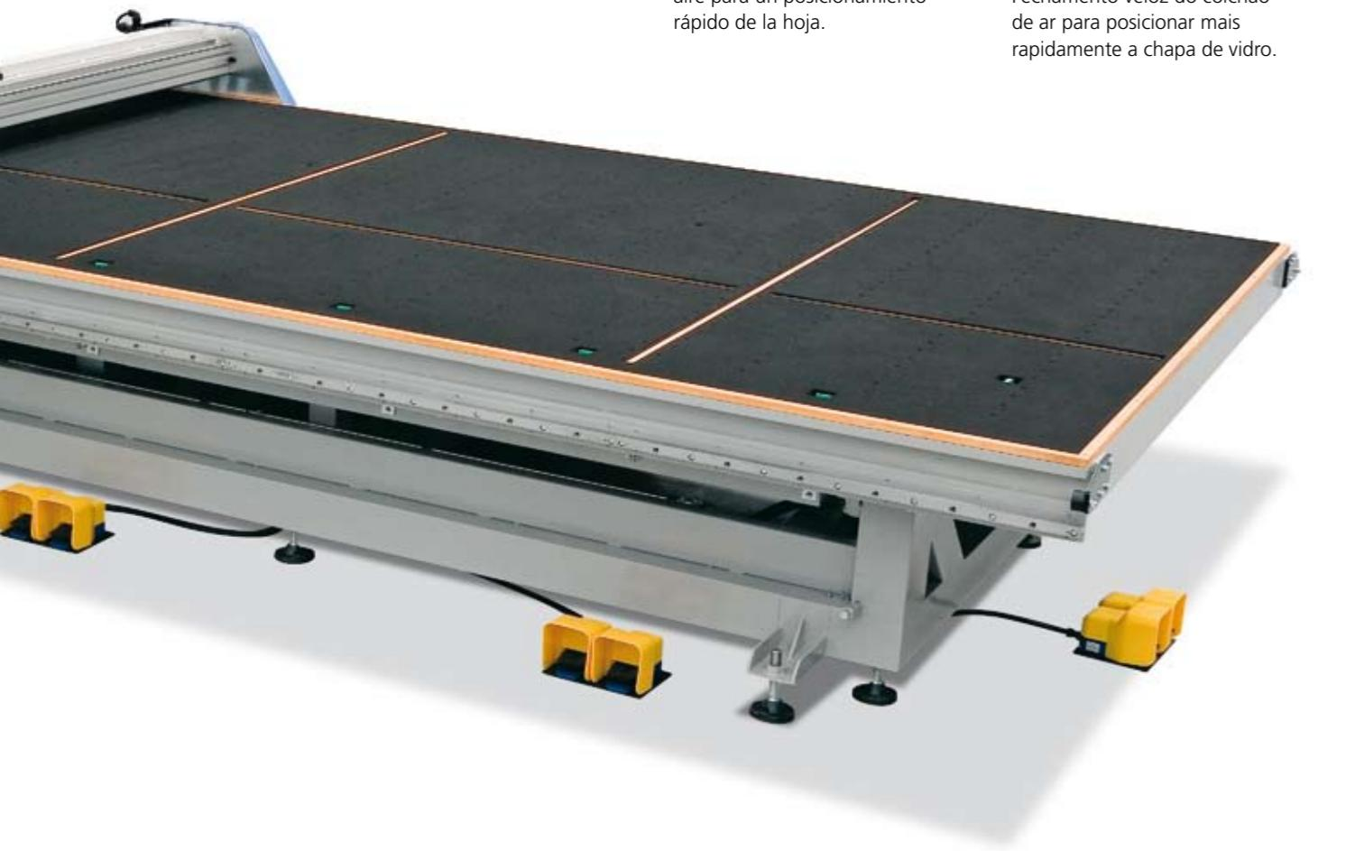
■ Automatischer Tisch zum Rechteck- und Formchnitt von monolithischem Glas.
