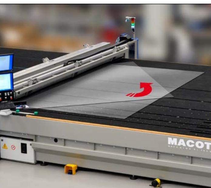
■ Dispositivi per la rotazione automatica dei vetri da 0 a 360° e scarico automatico dei vetri nel cassetto.
