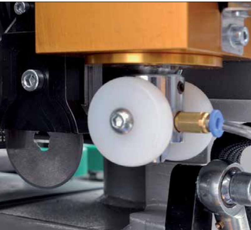
■ La lama per il PVB, controlla l'avvenuta apertura del vetro prima di iniziare il processo di taglio del film plastico, garantendo un ciclo di taglio veloce ed un'eccellente qualità del bordo.
