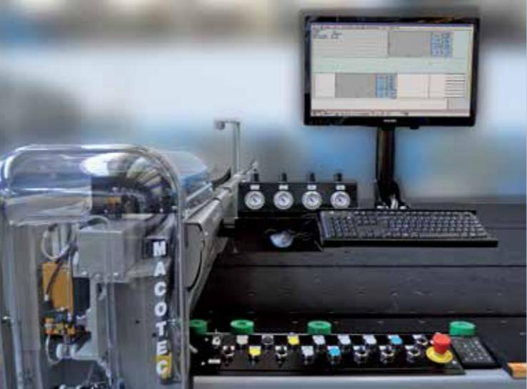
■ Macchina equipaggiabile anche con unità di controllo computerizzata e di ottimizzatore con visualizzazione grafica delle diverse fasi di lavorazione.
