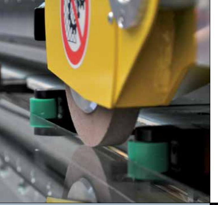
■ Alle Modelle Active können mit einer Umfangschleifscheibe für die Randbeseitigung der Low-E Schicht ausgestattet werden. Diese Beseitigung kann dank der Glaspositionierung Quote Null sogar auf dem Außenrand der Glasscheibe durchgeführt werden.
