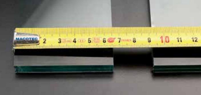
■ Esecuzione completamente automatica di rifiili minimi fino a 6,5 cm: ottimizzazioni efficienti e riduzione degli scarti di lavorazione.
